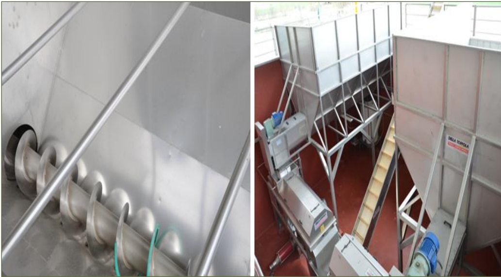
Imagen 27. Interior y exterior de una tolva en la Bodega Pinna Fidelis en Peñafiel (D.O.P. Ribera del Duero)
