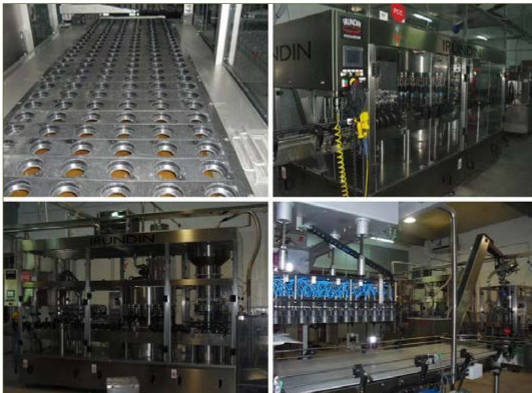
Imagen 35. Maquinaria utilizada para la limpieza, embotellado, etiquetado y capsulado de las botellas. Bodega Pinna Fidelis (D.O.P. Ribera del Duero)
