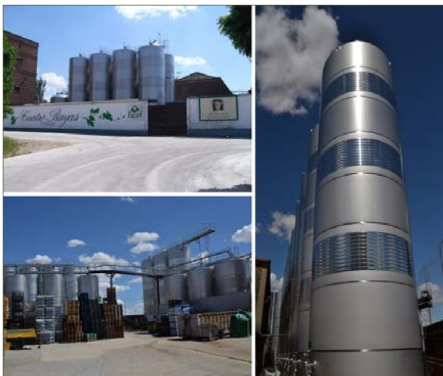
Imagen 31. Depósitos de acero inoxidable de la bodega Cooperativa Agrícola Castellana Cuatro Rayas. La Seca (D.O.P. Rueda)
